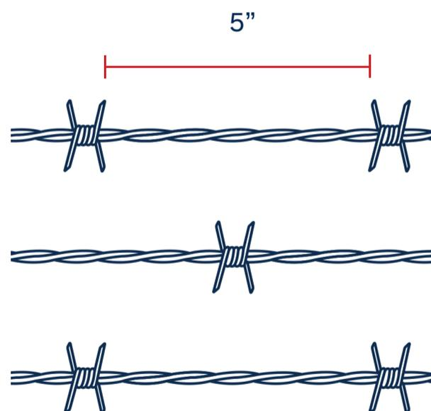
NORMAS DE FABRICACIÓN: ASTM A-121 / ASTM A-641 / NMX-B-518
